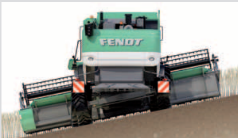
Nivelación en pendientes Auto-Level para alcanzar la máxima potencia en pendientes con una inclinación de hasta el 12%
