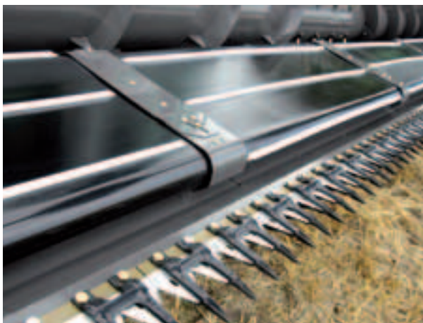
Las cuchillas se conducen de arriba abajo y presentan una capacidad de carga especialmente buena.
