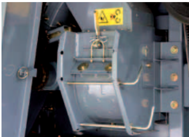
La retrilla independiente aumenta la potencia incluso en la trilla posterior.
