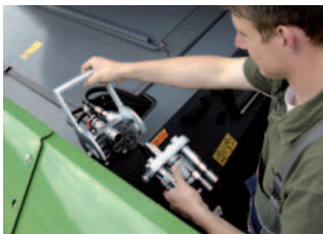
Muy sencillo: Gracias al acoplador múltiple las conexiones hidráulicas del cabezal pueden acoplarse en una sola maniobra.
