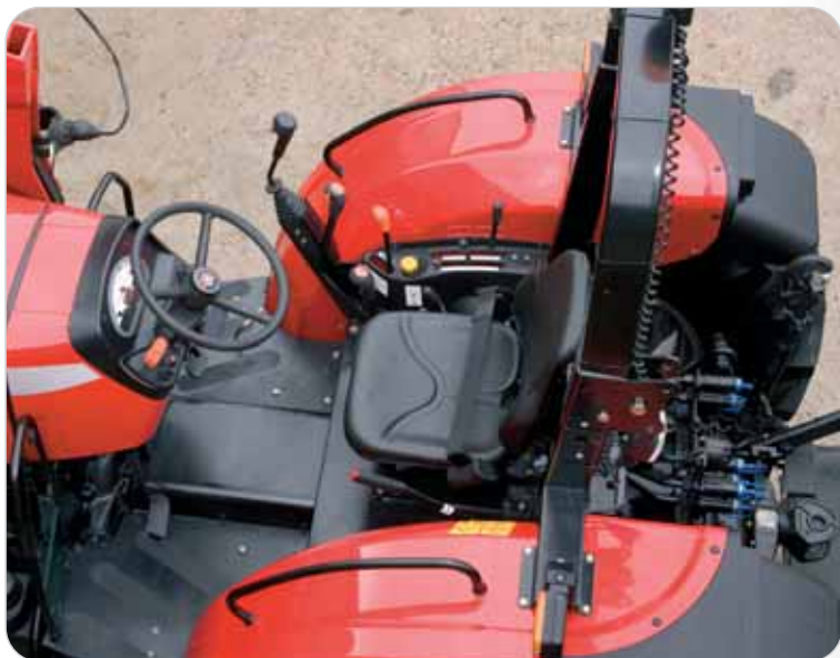
Espaciosa plataforma, con excelentes controles y protección mediante sistema ROPS plegable de 2 postes
