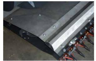
Posibilidad de variar el **ángulo de inclinación** de la plataforma para permitir una mejor penetración en los productos aleteados o tipo soja.
