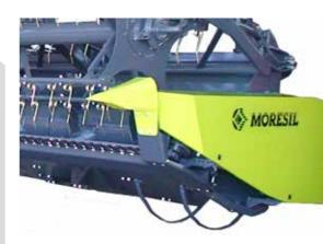
**Molinete de gran diámetro** para cosechar en cualquier tipo de condiciones y de velocidad regulable hidráulicamente por el conductor.
