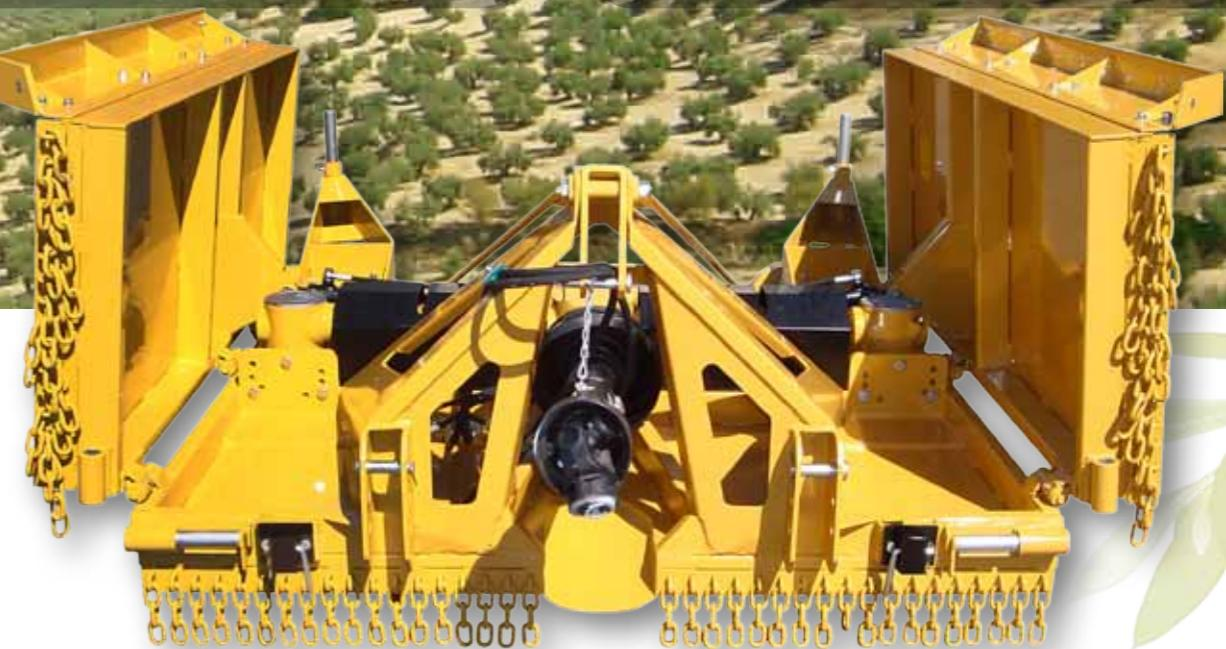
Con la desbrozadora plegable se consigue el mantenimiento de una cubierta vegetal, siendo una técnica enmarcada en las prácticas de no laboreo y complementaria al aporte de restos vegetales a la superficie del suelo en el control de la erosión.
