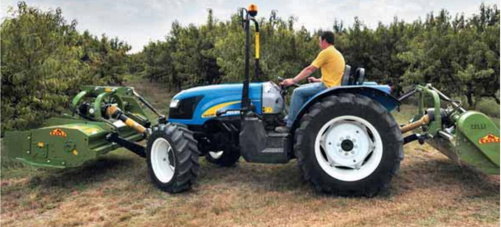
Todos los modelos de la Serie TD4000F llevan dos bombas independientes: una para la dirección y otra para el sistema hidráulico. Ésto garantiza que haya suficiente potencia hidráulica disponible en todo momento. Para aplicaciones más exigentes, puede instalarse una bomba MegaFlow™ de 55 l/min de gran capacidad. Pueden instalarse hasta cuatro distribuidores traseros y dos distribuidores laterales, controlados mediante joystick.
