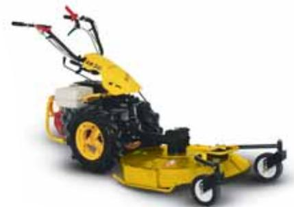
*O motocultivador **SB30 PLAY** tem uma caixa com 3 velocidades para a frente - 2 velocidades para trás e um inversor rápido do sentido de marcha. Equipa de série com um diferencial com bloqueio, para que a máquina seja mais prática e manejável. O guiador de direcção é regulável e reversível, permite a utilização de alfaias posteriores e anteriores.*
