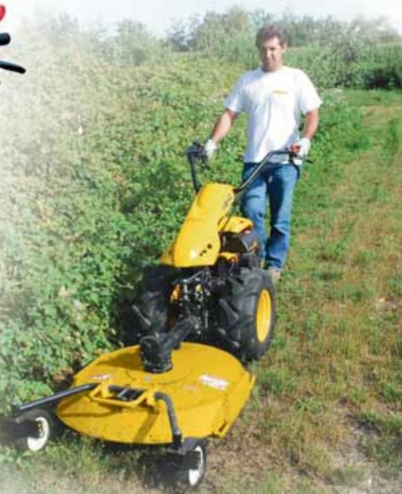
*O motocultivador **XB40 PLAY** está equipado com uma caixa de 4 velocidades para a frente e 3 velocidades para trás e um inversor rápido no sentido de marcha, permitindo trabalhar com várias velocidades, adaptando-se aos diversos tipos de utilização. O diferencial com bloqueio é de série. O guiador de direcção é regulável e reversível para a utilização de alfaias anteriores e posteriores. Os travões são com accionamento independente sobre as duas rodas.*
