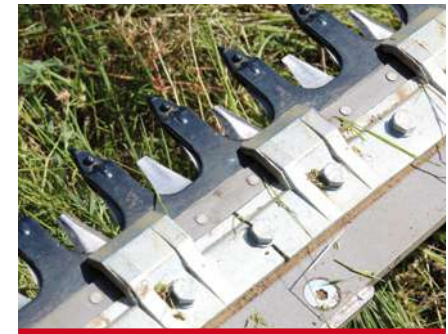
Sistema di sicurezza in caso di urti contro ostacoli. / Automatic safety release to protect the bar from any obstacles. / Sistema de seguridad en caso de impacto contra obstáculos. / Système de sûreté à décrochage automatique à surmonter l'obstacle.
