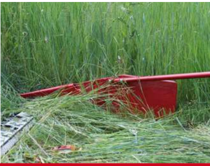
Bandella in lamiera per la formazione dell'andana. / External shoe for windrow formation. / Hoja en acero para la formación de la hilera. / Feuillard en tôle pour la formation de l'andain.
