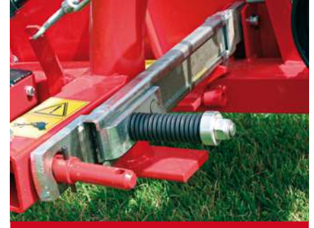
Sistema di sicurezza in caso di urti contro ostacoli. / Automatic safety release to protect the bar from any obstacles. / Sistema de seguridad en caso de impacto contra obstáculos. / Système de sûreté à décrochage automatique à surmonter l'obstacle.
