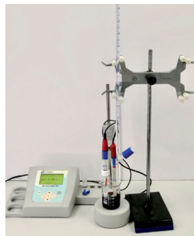
Figura 20. Medida de acidez total por potenciometría
