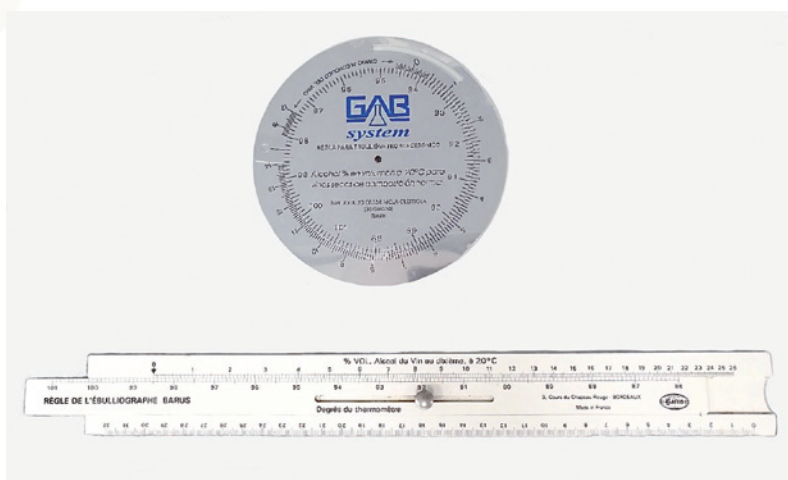
Figura 24. Ábacos para el cálculo del grado alcohólico por ebulliometría
