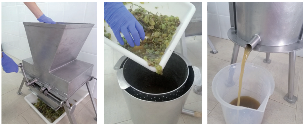
Figura 6, 7 y 8. Proceso de estrujado, trasvase de la masa al jaulón de la prensa, prensado y obtención del mosto
