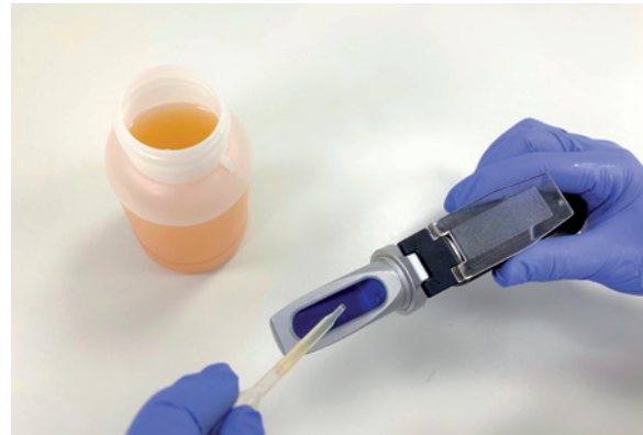
Figura 14. Carga de muestra en el refractómetro manual
