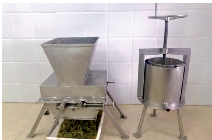
Figura 5. Estrujadora y prensa manuales utilizadas para la extracción de mosto de muestras de uva blanca
