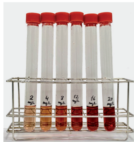
Figura 31. Disoluciones patrón para la determinación del contenido de hierro
