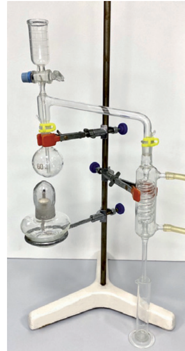
Figura 27. Montaje Mathieu para determinación de acidez volátil
