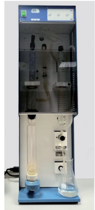
Figura 25. Equipo de destilación por arrastre de vapor
