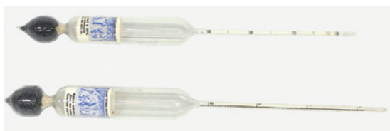
Figura 16. Densímetros escalados en g/dm 3 a 20 °C
