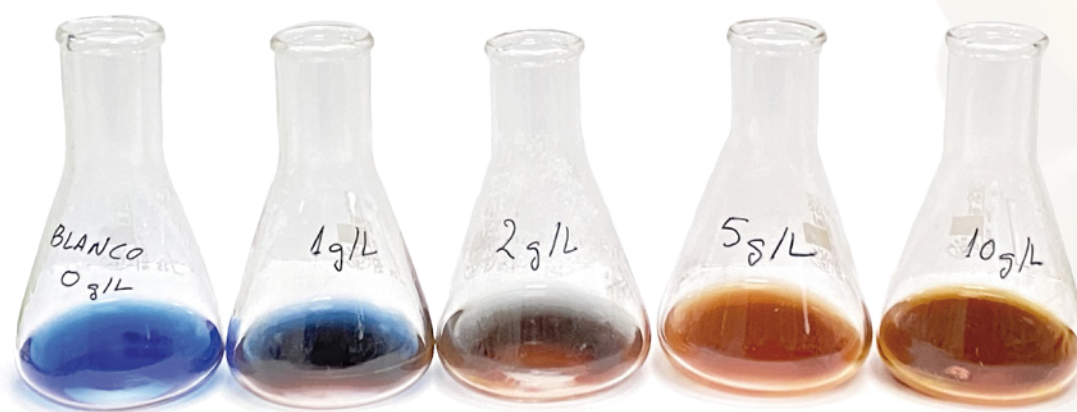
Figura 21. Análisis cualitativo de fin de fermentación alcohólica. De izquierda a derecha: blanco con 0 g/L de azúcares reductores, muestra de vino con 1, 2, 5 y 10 g/L de azúcares reductores
