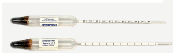
Figura 17. Areómetros con escala °Bé a 15 °C
