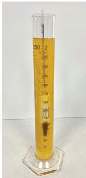
Figura 18. Determinación de sólidos solubles por areometría
