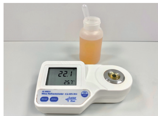
Figura 15. Refractómetro digital con corrección de temperatura
