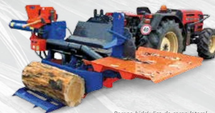
Rampa hidráulica de carga lateral.
