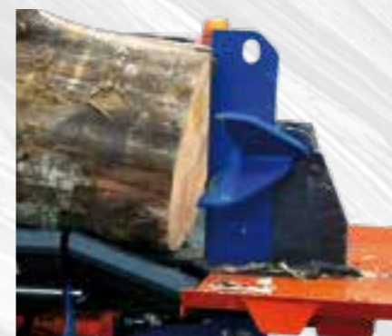
Cuchilla ajustable hidráulicamente (disponible en 2/4 o 2/6).
