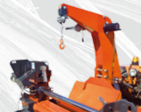
Cabrestante de 1t opcional con desenrollado automático.
