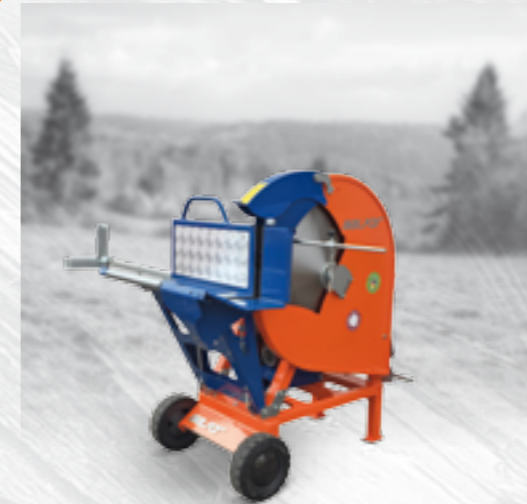
Banco oscilante con rodillos para una alimentación sencilla y plancha metálica para evitar el movimiento del tronco durante el corte.
