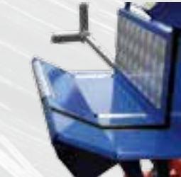
Banco oscilante con rodillos para una alimentación sencilla y plancha metálica para evitar el movimiento del tronco durante el corte.
