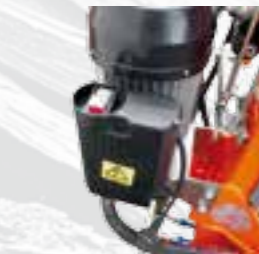
Interruptor de encendido con sistema de seguridad térmico.
