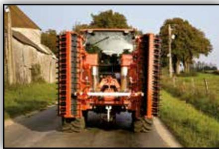
Todas las gradas rotativas Kubota incorporan un grupo de engranajes que permite el cambio de velocidades, por palanca o por cambio de engranajes según sea el modelo. El propio grupo incorpora una protección tarada desde 1.800Nm a 2.500Nm según el modelo consiguiendo el máximo con los tractores de hasta 350cv. El régimen de las azadas varía de 246 a 450rpm al entrar TDF a 1000rpm según sea el modelo PH1000F o PH2000F.
