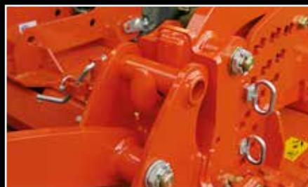
Los modelos PH2001 y PH3000 pueden incorporar como variante el enganche "Euro-Connection" para barras de siembra combinadas con grada rotativa. Este enganche, se parece al de las palas delanteras y facilita trabajar con la grada rotativa habiendo desmontado la barra de siembra.
