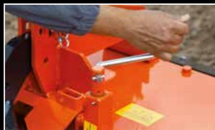
Ajuste con husillo de la barra niveladora trasera y protección de seguridad con muelle.
