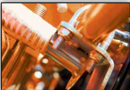
La posición de la descarga de semilla es ajustable y por delante del rodillo.
