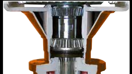
Eje porta-azadas, sujeto por dos cojinetes cónicos, bien separados, de alta resistencia.
