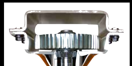
Sección del cárter de máxima estabilidad de una grada rotativa PH3000.
