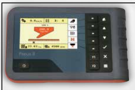
Focus 3 es el terminal del sistema e-bas. Controla todas las funciones de la sembradora. NO es ISOBUS
