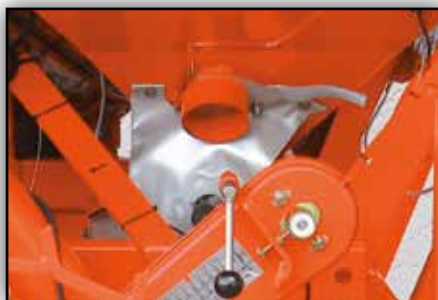
Orificio de vaciado total de la tolva justo encima del dosificador.
