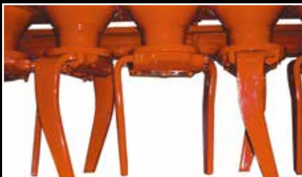
Las carcasas de los módulos de las azadas están soldadas al cárter lo que le transfiere aún mayor resistencia. La amplia separación entre la plancha interior del cárter y el soporte de las azadas facilita el paso de rastrojo y piedras sin obstrucciones.
