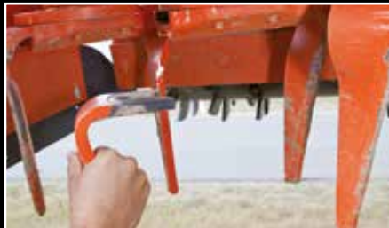
Azadas Quick-Fit. Se sujetan mediante un bulón con un pasador elástico. Es posible sustituir todas las azadas de la máquina sin necesidad de herramientas.
