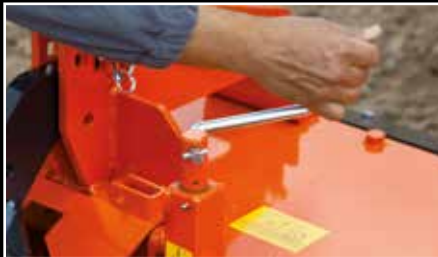
Ajuste con husillo de la barra niveladora trasera y protección de seguridad con muelle.
