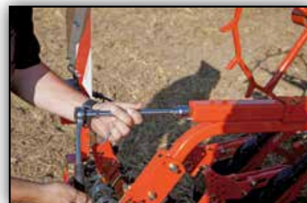
Ajuste manual del ángulo y presión de la rastrilla trasera.
