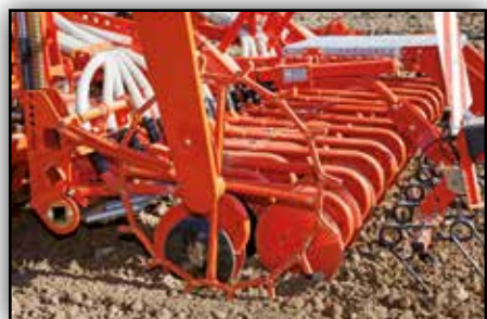
La rueda de tracción del dosificador incorpora un freno automático al elevar la máquina en cabecera.
