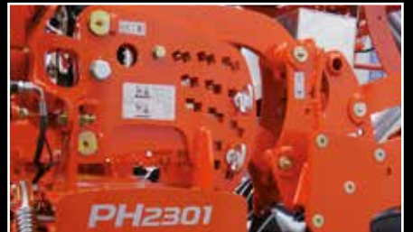
El ajuste de la profundidad de trabajo se realiza sobre el cárter, reduciendo la transmisión de esfuerzos hasta el cabezal.
