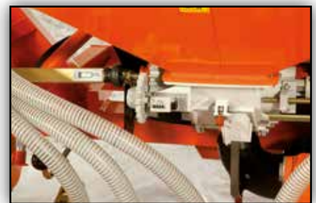
El ajuste del sistema de dosificación, no requiere herramientas.
