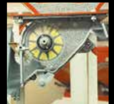
Disposición para semillas muy pequeñas, con cepillo de limpieza.
