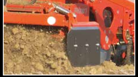
Deflectores retenedores laterales flotantes y con muelle de seguridad anti sobrecargas.
