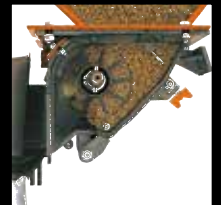
Disposición para semillas de tamaño promedio, trigo, cebada...
