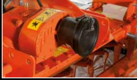
Robustos grupos de transmisión con relación de engranajes intercambiables.
