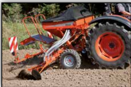
Diseño compacto para minimizar la demanda de capacidad de elevación del tractor.
