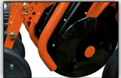
Disco CX II con doble entrada para abono (tubo rojo) y semilla (tubo negro) todo en un solo pase.
