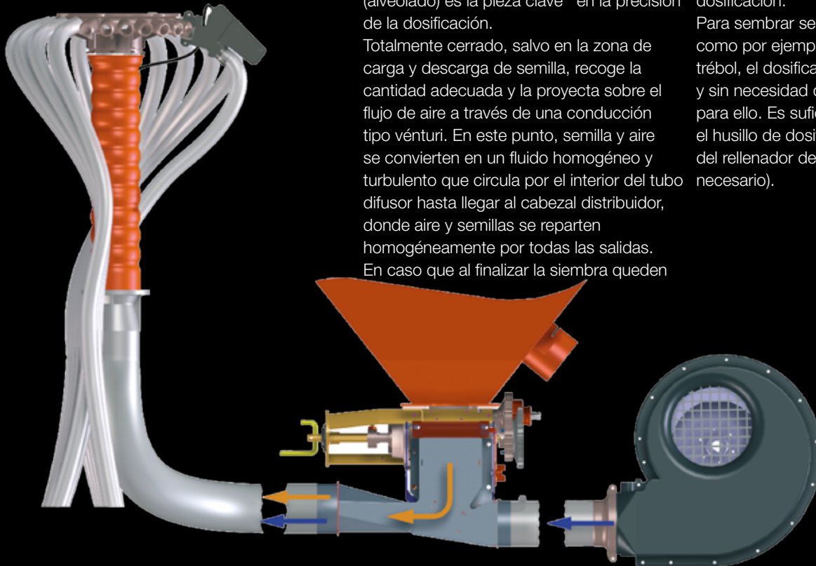
Disposición para semillas de tamaño promedio, trigo, cebada...
