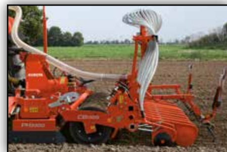
La barra de siembra se acopla al preparador por medio del sistema especial de enganche Kubota. Ello permite que las botas y discos de siembra, mantengan siempre la profundidad de siembra uniforme.
