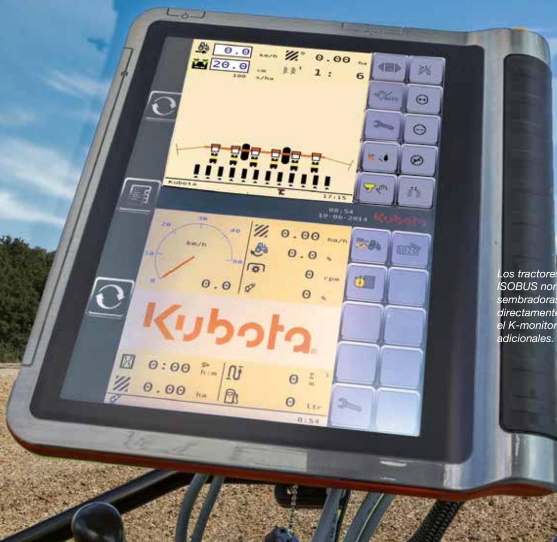
Los tractores Kubota de la serie M7001 son ISOBUS norma 11783. Esto significa que las sembradoras de ISOBUS pueden conectarse directamente al tractor y controlarse desde el K-monitor sin inconvenientes ni equipos adicionales.
