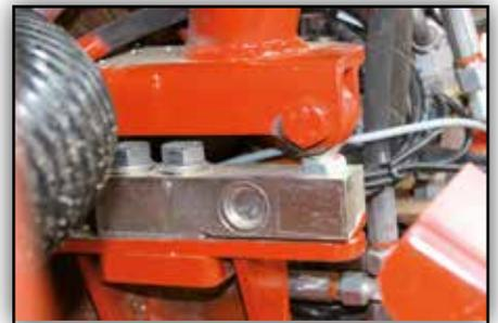
*Células de carga (balanza) electrónicas para ajuste preciso de la aplicación de abono.*
