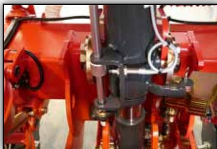
Excelente seguimiento del terreno con cilindros de doble cámara para las ruedas de apoyo.
