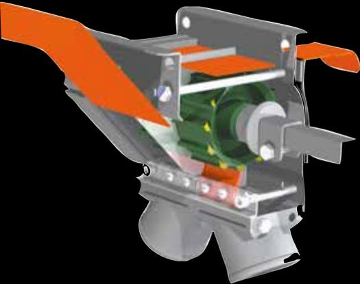
Dosificación del volumen exacto mediante rodillo acanalado
