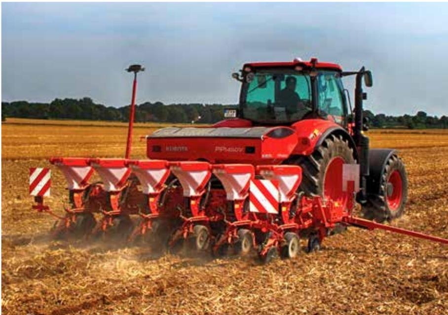
PP1450V e-drive II con 6 hileras, de 4,5m de ancho telescópico. Abonador de 1000 litros.
