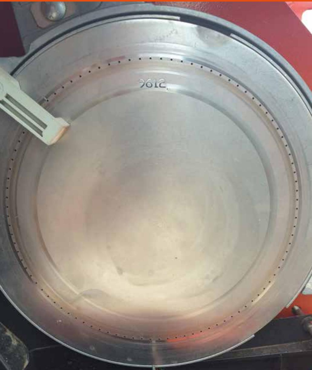
Para la siembra de la colza es posible solicitar como Variante un Kit especial. El disco tiene 96 orificios que se limpian permanentemente mediante una especie de disco dentado limpiador transversal (ver esquema inferior) que asegura que los orificios están siempre libres, evita bloqueos y asegura la calidad de siembra de la Colza.
