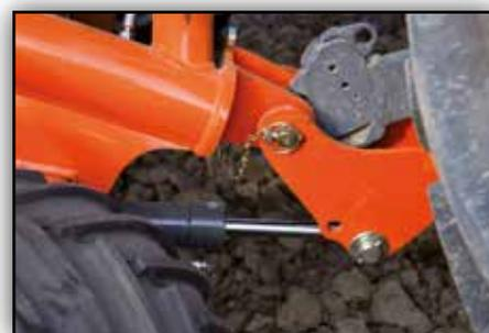
Transmisión de peso hidráulica (variante)
