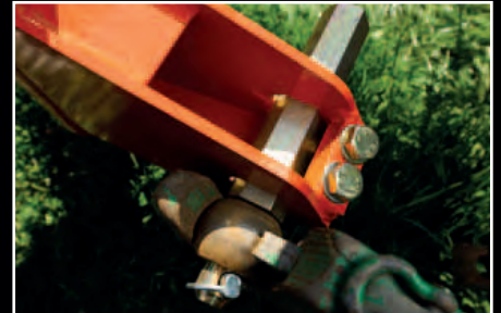
Los bulones de acoplamiento ajustables facilitan la adaptación de la máquina a la anchura del tractor.
