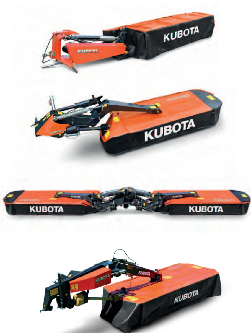
Kubota DM2000, DM3000 y DM3300, equipadas con seguridad Non-Stop.
