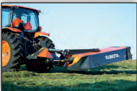
Alzado hidráulico en cabeceras con amplio despeje.
