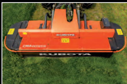
La línea de accionamientos está preparada para trabajar tanto a 1.000 como a 750 r.p.m. invirtiendo la posición de las poleas de transmisión.
