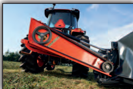
Transmisión mediante correas "V".
