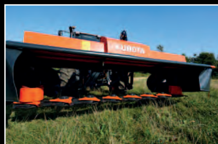
Fácil acceso a la barra de corte con la cubierta y laterales abatibles.
