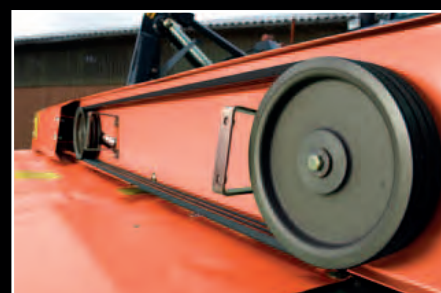
Ajuste de la velocidad de entrada de la toma de fuerza por inversión de poleas.
