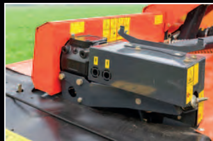
El sinfín es accionado con un grupo que sólo demanda 5 CV de potencia adicional.
