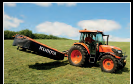
Alzado en caberas mediante cilindro hidráulico, sin utilizar el tripuntal del tractor.
