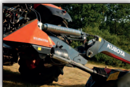
Muelle de compensación ajustable para mantener la flotación de la barra de corte.
