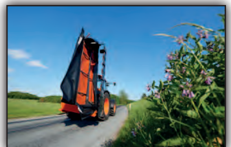
En transporte la máquina se pliega hidráulicamente en posición vertical tras el tractor, facilitando el desplazamiento entre campos.
