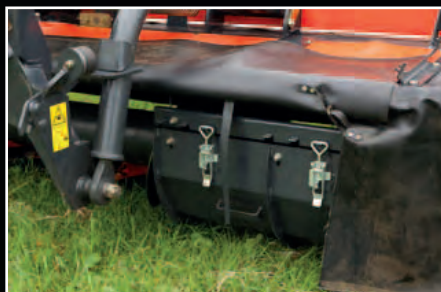
Fácil ajuste del ancho de hilera modificando la posición de los deflectores traseros.
