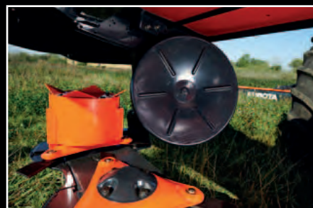
Los discos hileradores forman una hilera de entre 2,2 y 2,4 metros de ancho.
