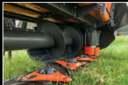
Formación activa de hilera mediante el sinfín.
