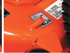
Tubería de limpieza de plataforma para conectar una manguera de agua
