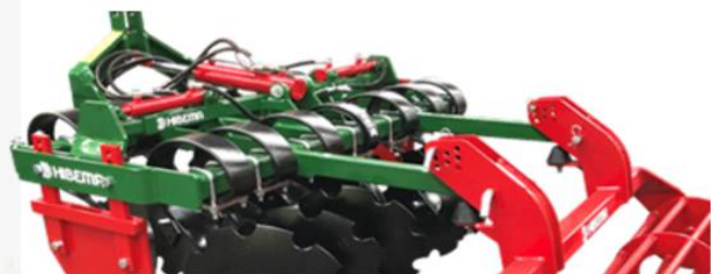
Detalle torreta plegable y extensible hidráulico
