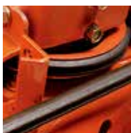
Correas de la plataforma de tipo hexagonal de alta duración (El eje está cubierto.)
