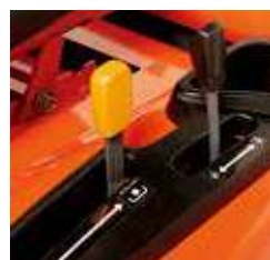
Control hidráulico para subir/bajar la plataforma de siega
