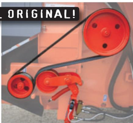
La transmisión POLYDRIVE® del picador consiste en una transmisión de correas desembragable hidráulicamente que ofrece numerosas ventajas, entre las cuales :
