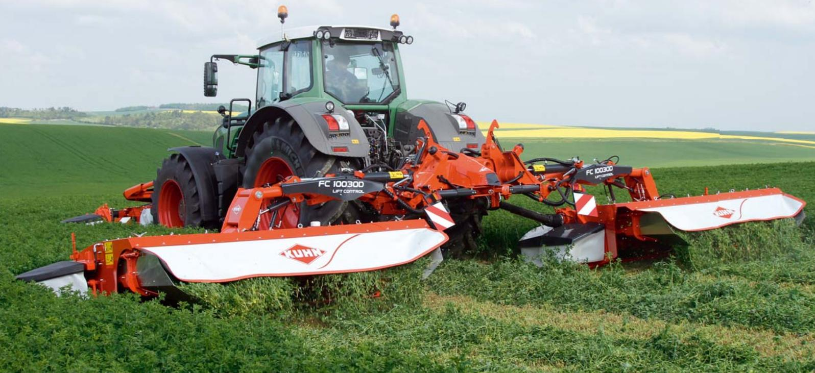
Las tres nuevas segadoras acondicionadoras de KUHN ofrecen unas anchuras de trabajo excepcionales de 8,73, 9,53 y 9,93 m (en función de la unidad frontal utilizada). Estos modelos reúnen todas las ventajas de las segadoras plegables GMD 9530 y 10030, pero con una ventaja adicional: un acondicionador eficaz.
