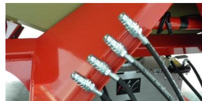
Los tubos hidráulicos desconectados del tractor, deben ser sujetos a los soportes adecuados previstos para dicha finalidad.
