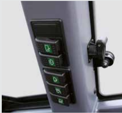
Barra de interruptores, enchufe eléctrico
