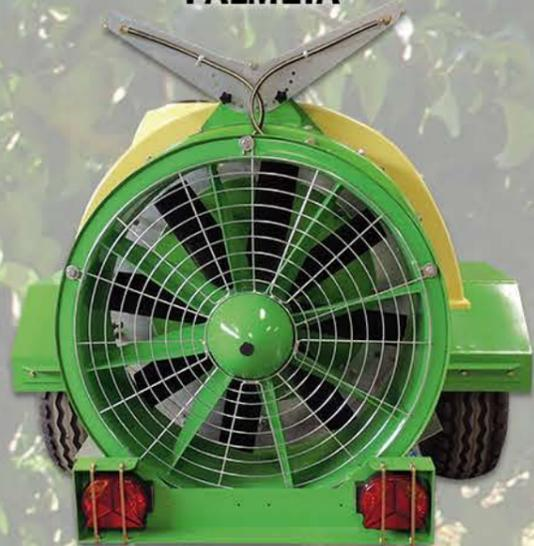
**TURBOCANALES DE ENTRADA Y PARACHOQUES REFORZADO**
