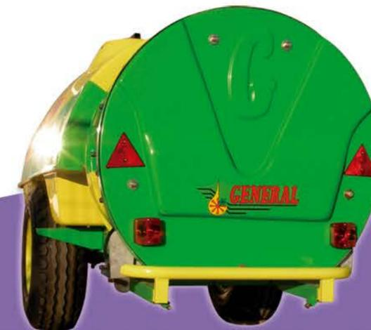
**ATOMIZADORES ARRASTRADOS DYNAMIC INVERT CON DEPÓSITO DE POLIETILENO Y ASPIRACIÓN INVERSA,**
