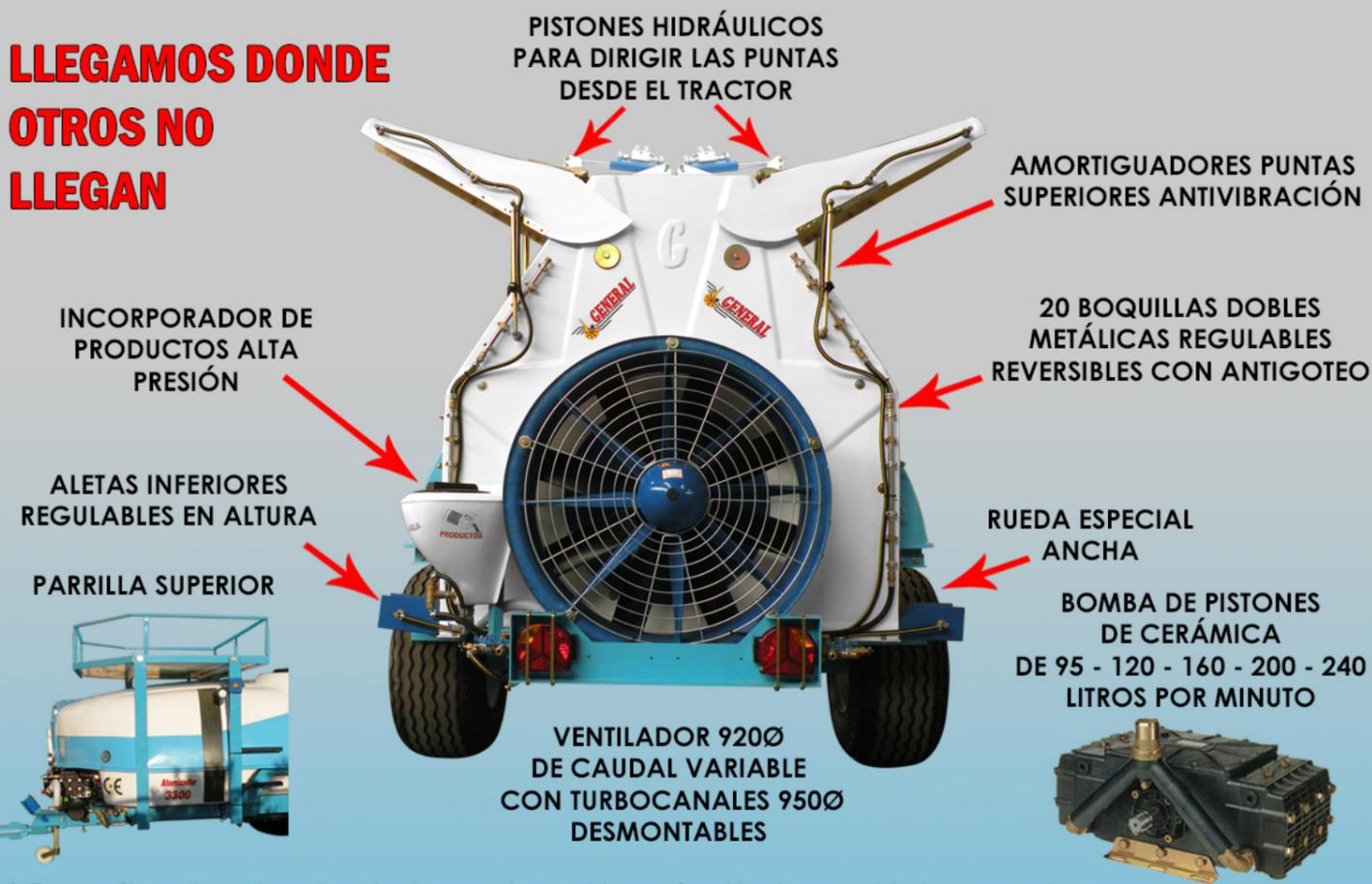
\* Fotografías orientativas, la máquina puede cambiar en función de capacidad y accesorios.
