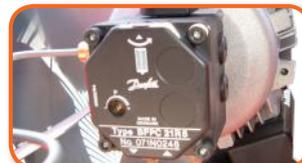
Bomba de inyección de gasóleo a alta presión, diseñadas para trabajar 24 horas al día. Es capaz de aspirar gasóleo de un depósito nodriza a 15 m.de distancia.
