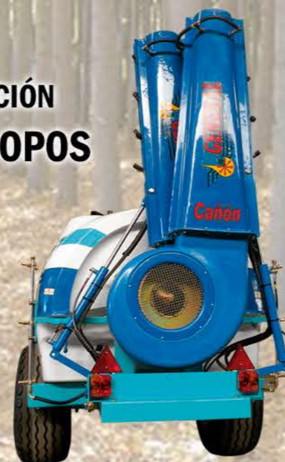
OPCIONAL ORIENTACIÓN DE 2 CAÑONES CON 2 PISTONES HIDRÁULICOS
