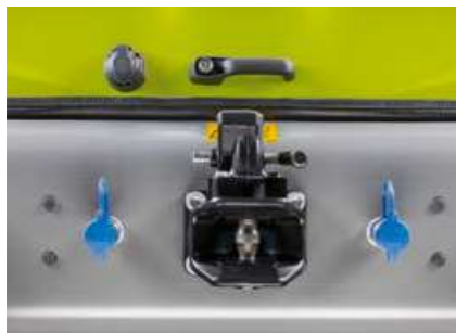
En la parte trasera se encuentran dos acoplamientos rápidos hidráulicos adicionales.
