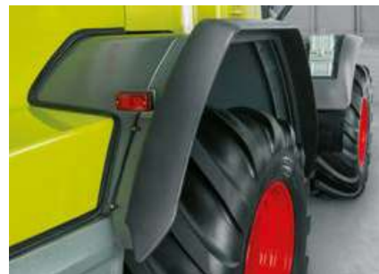
Para cubrir por completo ruedas especialmente anchas, los arcos de rueda pueden ser ensanchados con piezas distanciadoras.
