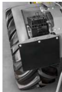
En la TORION 1511 P puede graduar de forma flexible los guardabarros para trabajar sin chocar en el silo.
