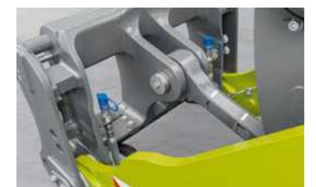
Está todo preparado para dos conexiones hidráulicas adicionales.
