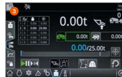
El sistema de pesaje mide y documenta de forma precisa la cantidad manipulada diaria.
