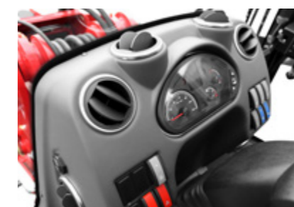
Salidas de aire adicionales y más grandes para una circulación de aire perfecta
