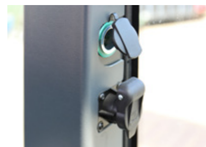
Toma de corriente de 12 voltios para cargar dispositivos móviles / toma de dispositivo de 3 pines
