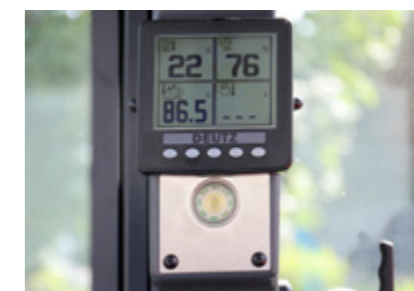
Nueva pantalla de información en la columna B para el sistema de gases de escape
