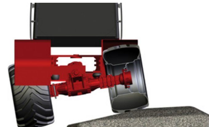
El eje trasero es oscilante para la mejor estabilidad. La suspensión opcional proporciona un funcionamiento más seguro y más cómodo.
