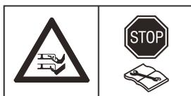
**ADVERTENCIA:** Active el dispositivo de desactivación antes de trabajar en la máquina o levantarla.
