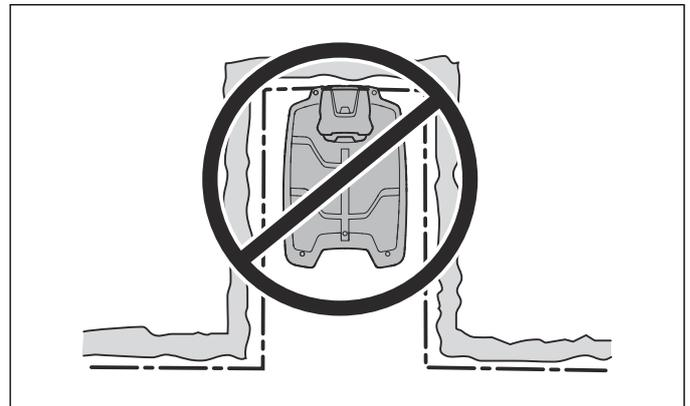
La estación de carga debe colocarse sobre una superficie nivelada. El extremo delantero de la estación de carga no se puede colocar en una posición superior o inferior en comparación con la parte posterior de acuerdo con la imagen a continuación.
