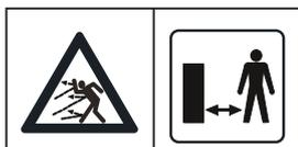
**ADVERTENCIA:** Manténgase a una distancia de seguridad de la máquina cuando esté en funcionamiento. Mantenga las manos y los pies alejados de las cuchillas giratorias.
