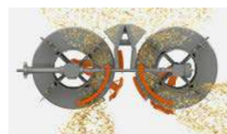
Distribuidor radial para un eficiente reparto de la paja con una mínima necesidad de fuerza.
