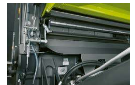
El gran dispositivo recogedor de piedras se deja abrir y vaciar fácilmente.
