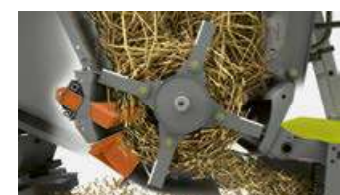
Contracuchilla y elemento giratorio de fondo en el picador SPECIAL CUT.
