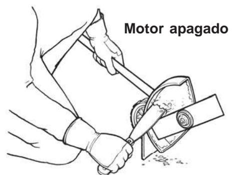
Retirada de residuos con el raspador
