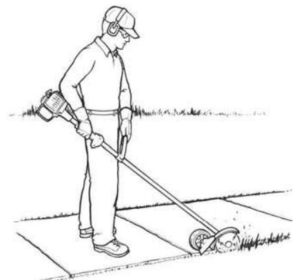
Coloque la bordeadora en el lado derecho del operador solamente
