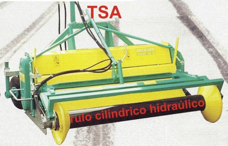
**rulo cilindrico hidraulico**
