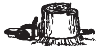
KICK GUARD® PROTEGE LA CADENA CONTRA EL TERRENO AL CORTAR AL RAS.
