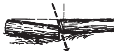
EFFECTÚE UN CORTE EN ÁNGULO CUANDO UNA SECCIÓN PUEDA ASENTARSE CONTRA OTRA. ¡ALEJE EL CUERPO DE LA RUTA DE LA BARRA/ CADENA!
