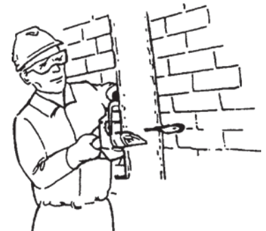
EL DISPOSITIVO KICK GUARD® PERMITE UN CORTE SIN RETROCESO CERCA DE MAMPOSTERÍA, CERCAS, ETC.
