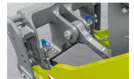
Está todo preparado para dos conexiones hidráulicas adicionales.
