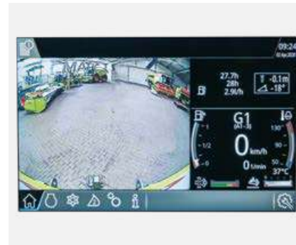
La cámara trasera se enciende automáticamente cuando mete la marcha atrás.
