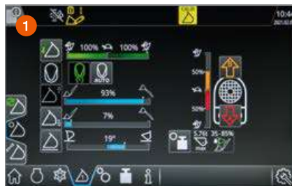
La limitación de la altura de elevación y de la profundidad de descenso graba la cercanía ideal al suelo y la altura de vuelco.
