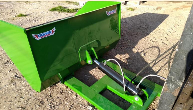
Chasis fabricado con tubo estructural de 160x60x5.
