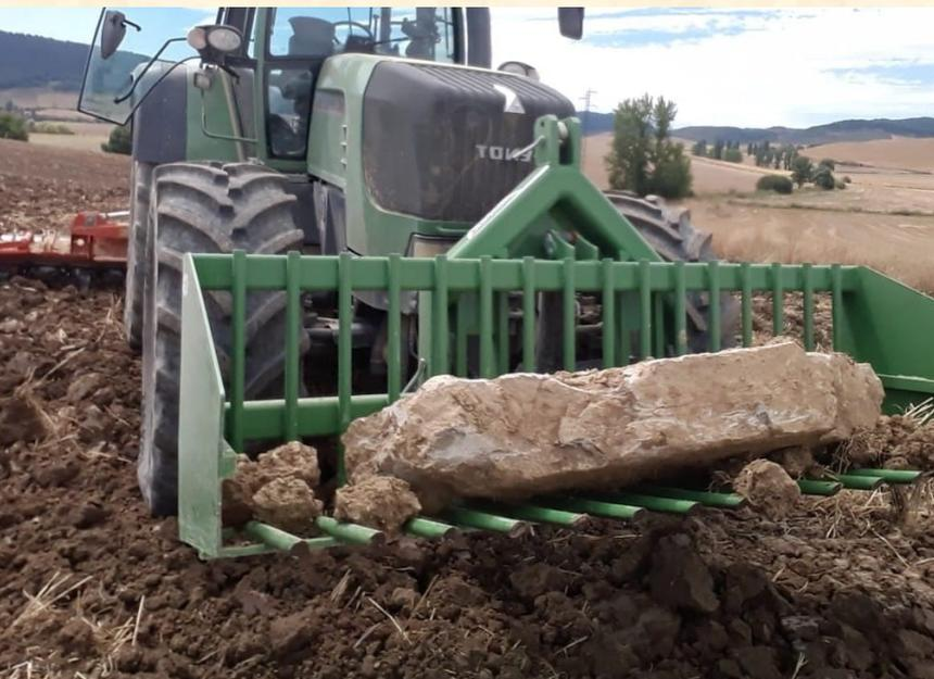
Chasis fabricado con torreta en chapa de 30mm.
