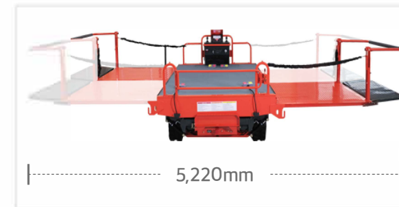
Longitud de las plataformas laterales extendidas
