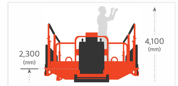
Máximo nivel de elevación de la plataforma y máxima altura para trabajar
