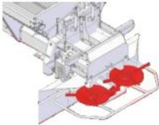
**El Sistema de distribución** es compuesto por dos discos y dos conjuntos de paletas, uno para aplicación de productos granulados y otro para aplicación de productos en polvo.
