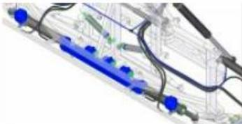
Sistema de Colgante estabilizador y muelles de amortiguación, con 30 metros de ancho y puntas en aluminio y iluminación auxiliar montada en las barras.
