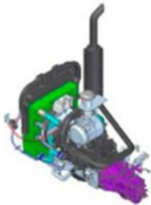
**Motor** MWM serie 12-4.12 TCE MAR-1-160cvs Turbo Aftercooler Electrónico. Transmisión. Eaton FS4205 B (5 velocidades delanteras y 1 a retro). Bajo consumo de combustible.
