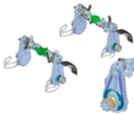
**Diferencial** autoblocante 1:4.625 y aceite lubricante tipo 140 w140. Transmisión de la rueda ASA 140 a baño de aceite y frenos con accionamiento hidráulicos, discos ventilados 4 ruedas.
