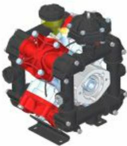
**Bomba** de pulverización de membrana 170 l/min, accionada por motor hidráulico. Grande salida y presión para los picos, garantizando óptima penetración del producto a aplicar. Flujo de líquido continuo, lubricada a aceite, altamente resistente a la acción corrosiva de los químicos.
