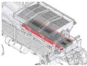
**Sistema de Distribución** con dos discos y con 4 paletas en cada disco, con 5 opciones de calibración y dos embudos direccionadores; siendo uno para distribución de fertilizantes y otro para distribución de productos en polvo.
