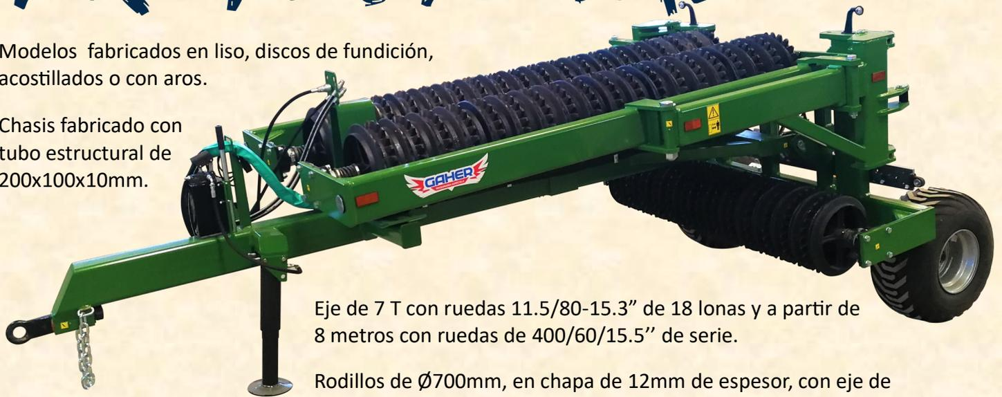
Eje de 7 T con ruedas 11.5/80-15.3" de 18 lonas y a partir de 8 metros con ruedas de 400/60/15.5" de serie.
