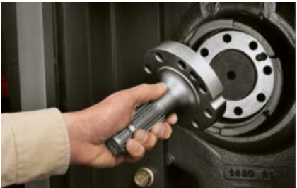
Cambio sencillo del terminal de la toma de fuerza.
