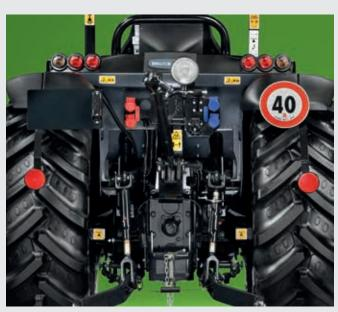
TDF de 3 velocidades y TDF sincronizada para adaptarse a cualquier aplicación.
