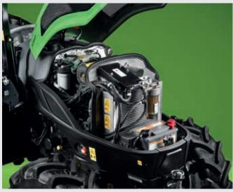
Motores conformes a la fase V con inyección common rail y potencias de hasta 59 CV.
