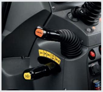
↑ Transmisión manual con inversor sincronizado
